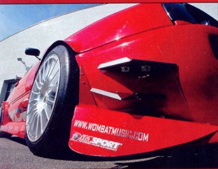
Ganz oben: Sparco Evo Carbonschale mit Dreiverschluss-Renngurten, drumrum die Überrollzelle Oben mitte: Scheinwerferersatz mit kleinem Abblendlicht und Gittereinsatz zum Luftfilter Oben: Belüftungsregelung am Dach Unten: RS-Front mit zahlreichen Flaps nach DTM-Vorbild aerodynamisch optimiert
